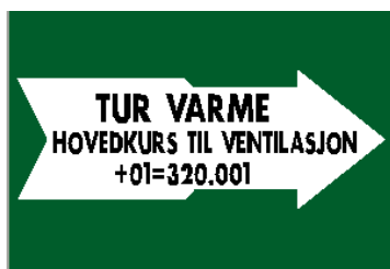
Figur 7-3 – Rørmerker med merkebånd som legges rundt røret med overlapp med individuell tekst i pil
