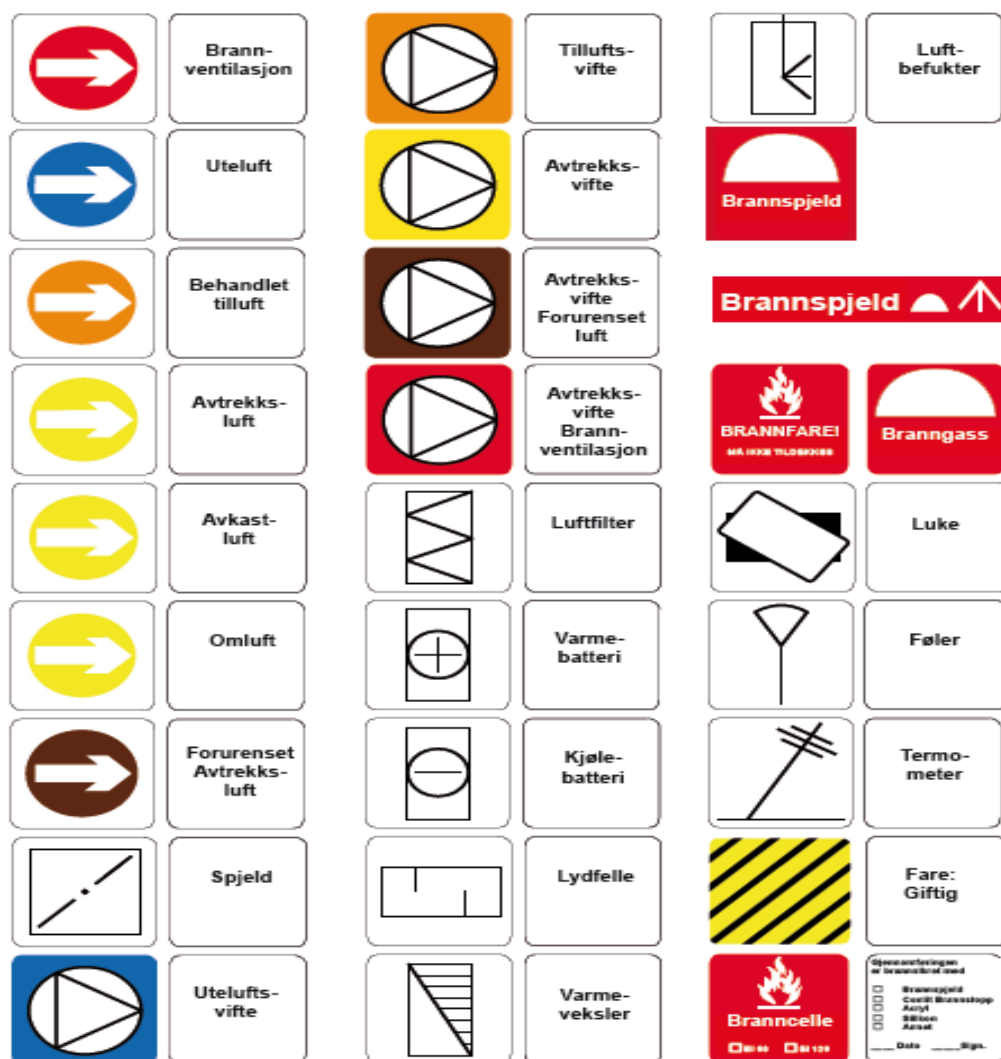
Figur 7-2 – Merking av ventilasjonsanlegg
